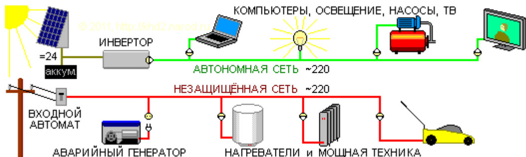
Рис. 2.1 Схема электроснабжения с автономным защищённым сегментом.
