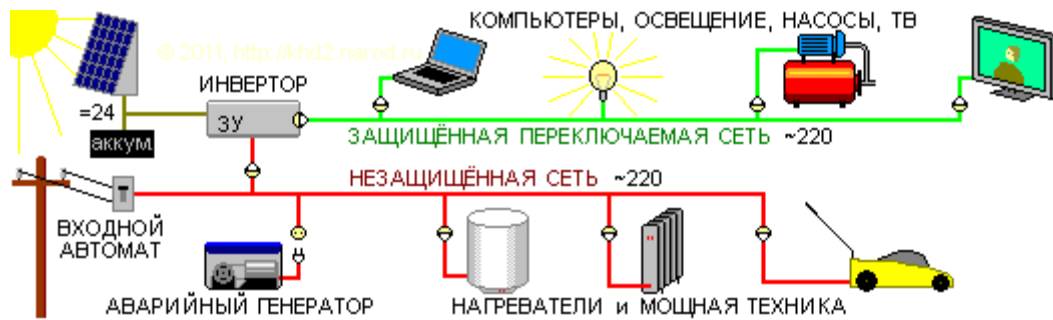
Рис. 2.2 Схема электроснабжения с переключаемым защищенным сегментом.
