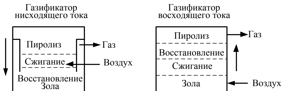
Рис. 14.1. Газификация способом нисходящего и восходящего токов
